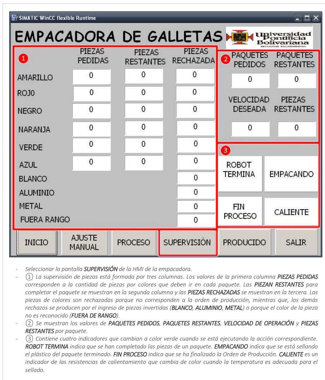
Figura 79. HMI Empacadora - Supervisión
