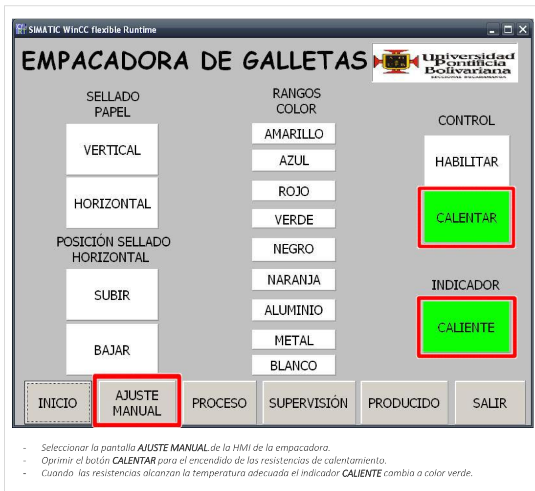
Figura 58. HMI Empacadora - Energizar resistencias de calentamiento
