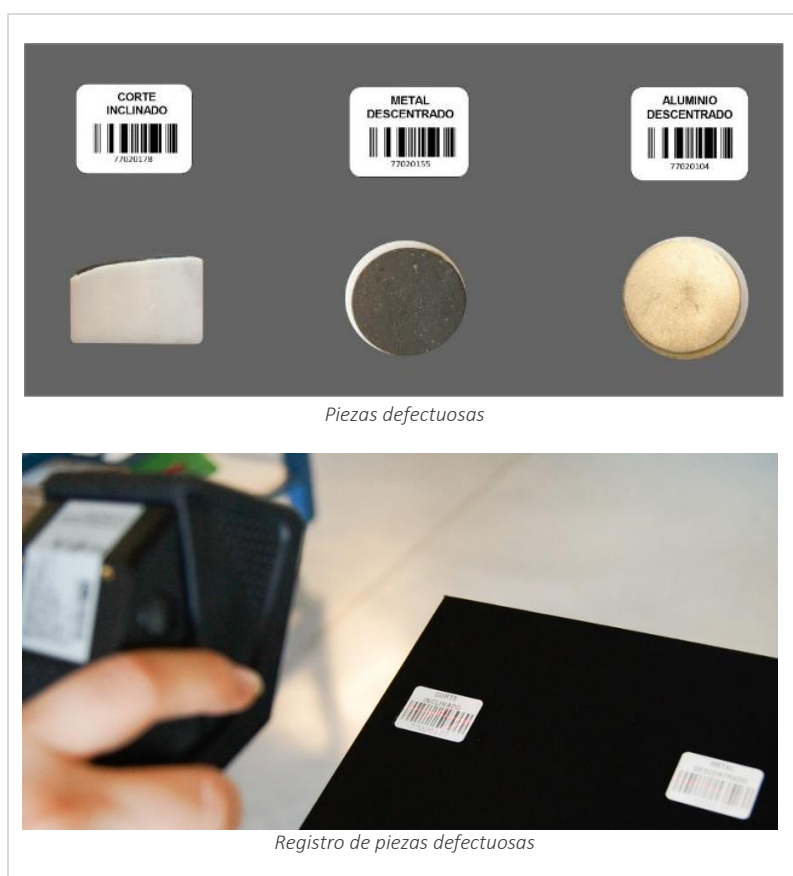
Figura 65. Control de rechazo de piezas
