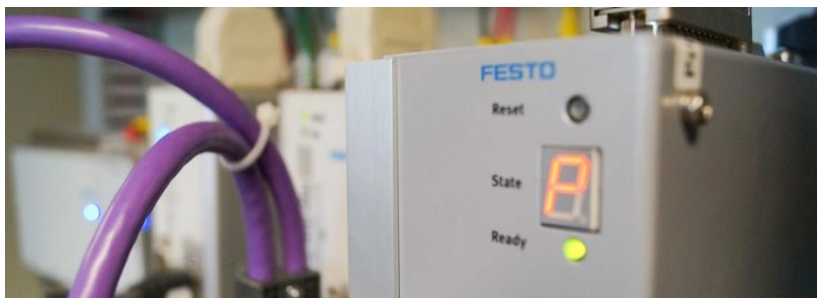
Indicadores del controlador del eje Z
