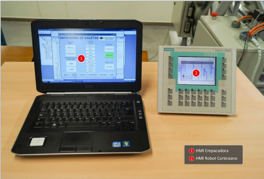
Figura 9. Nivel de supervisión de la línea de producción
