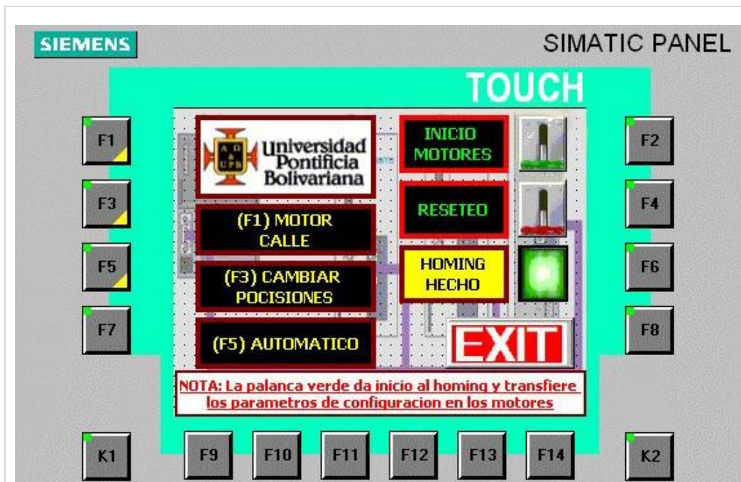
Pantalla de Homing en la HMI del Robot Cartesiano
