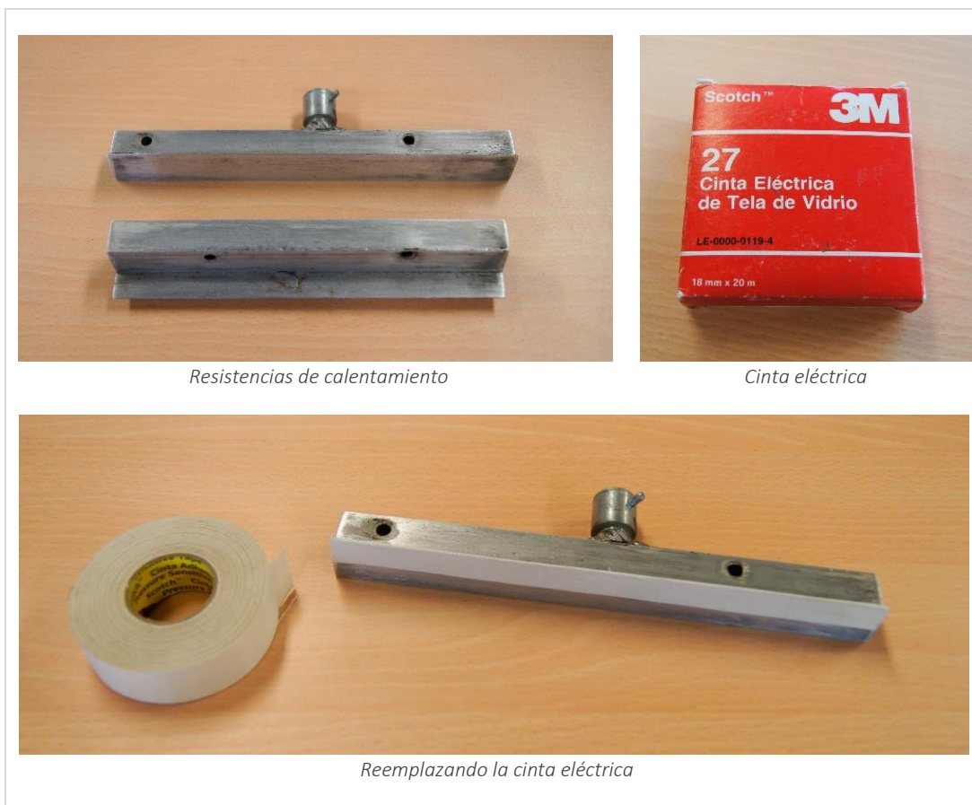
Figura 45. Limpieza de resistencias de calentamiento
