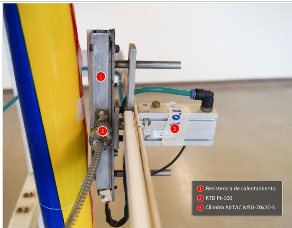
Figura 6. Unidad de Sellado vertical
