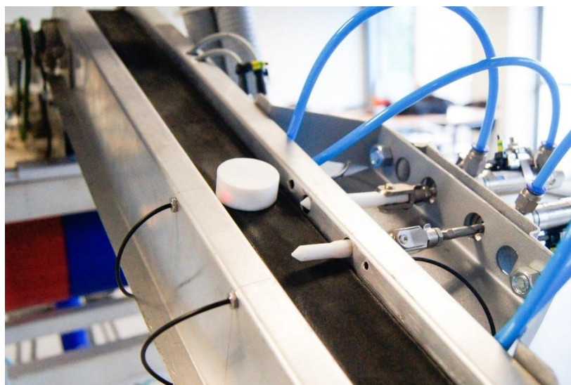
Figura 15. Control para el ingreso de piezas a Empacado
