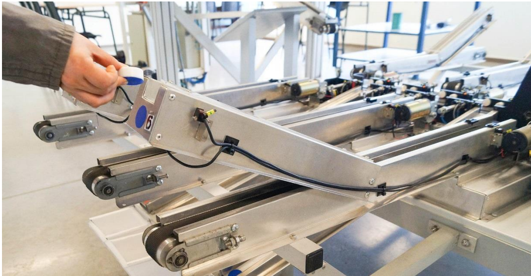
Figura 11. Ingreso de piezas etiquetadas a los canales de transporte
