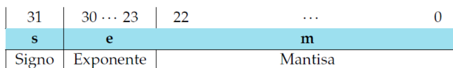
Figura 19. Distribución de bits para el estándar IEEE754 Precisión Simple [7]
